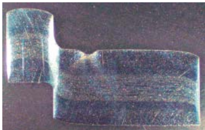
Bild 2: Fließ-Scher-Vorgang Quelle: Feintool
